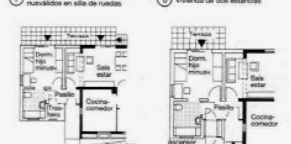
9 Anexo para minusválidos en garaje, planta existente. Rampa para salvar el desnivel
